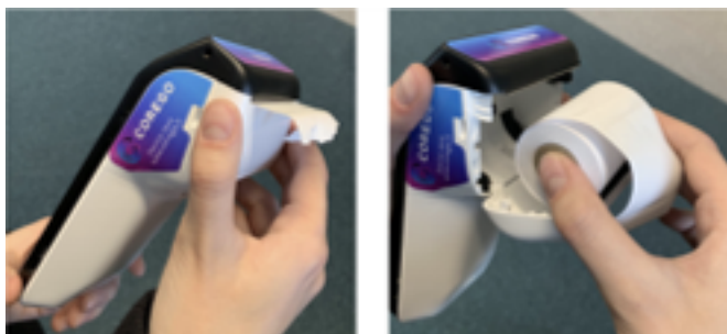
Bild 3. Öppna kvittolucka. | Bild 4. Sätt i kvittorullen åt rätt håll.
